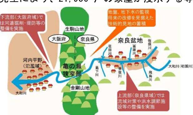
大和川上流部の治水対策は、洪水調節施設（遊水地）の整備や流域総合治水対策等を実施している。
