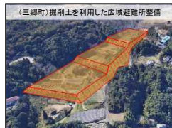
(三郷町)掘削土を利用した広域避難所整備
