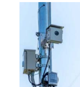
簡易型河川監視カメラ(設置例)
