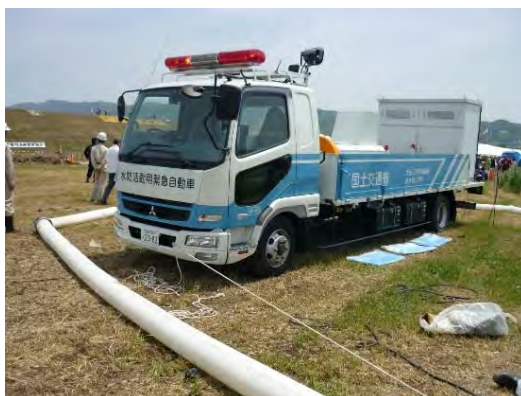
排水ポンプ車による排水
