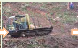
【林内作業車による運搬】
