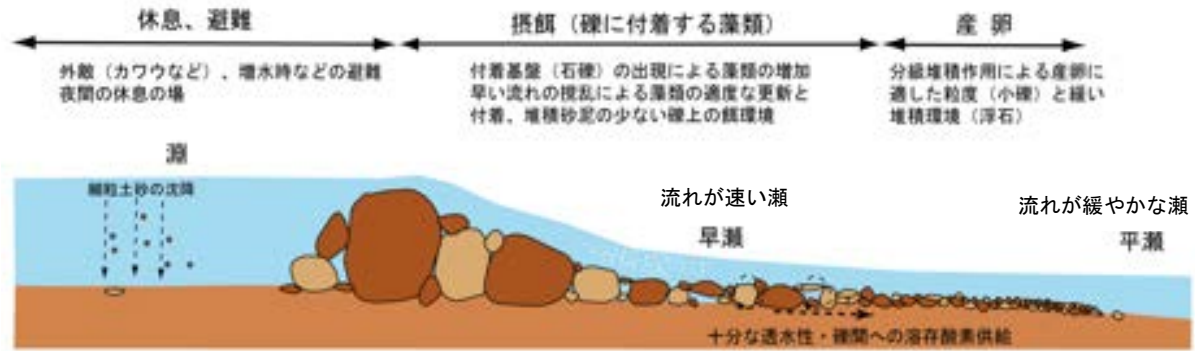
図 1.20 瀬と淵浄化施設の機能イメージ図
