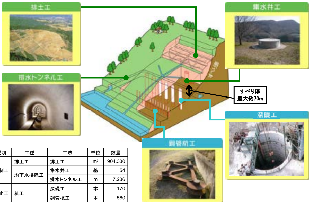
図 1.18 亀の瀬地すべり対策工模式図
