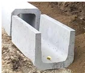
「自由勾配側溝」の特徴は、側溝の天端高さを水平にして、水路床の傾斜を自由に変えられることです。
