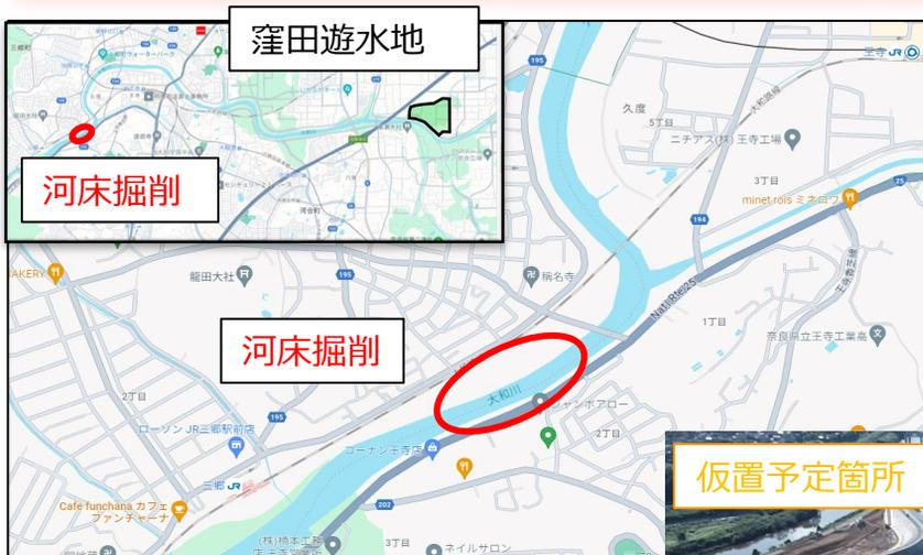
大和川の流下能力増大のため、立野南地区で河床掘削を行います。掘削土(約16,000m<sup>3</sup>)は、ゴミ中間処理施設の造成に利用するため、窪田遊水地内に一旦、仮置きします。
