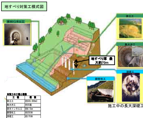
図 1.20 亀の瀬地すべり対策工模式図
