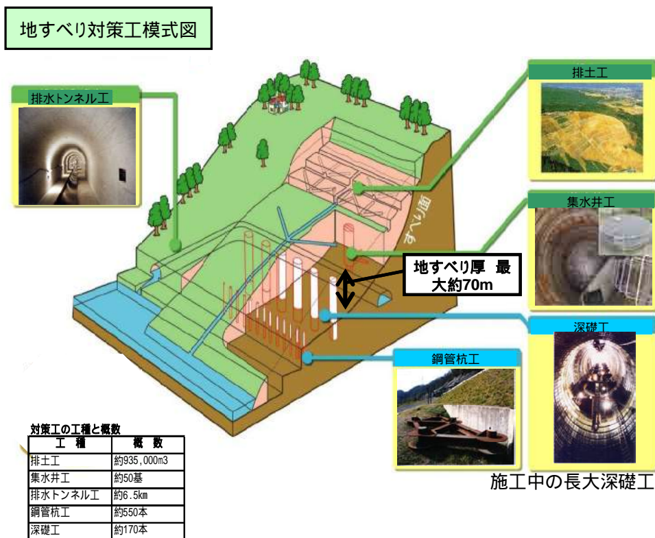
図 1.18 亀の瀬地すべり対策工模式図
