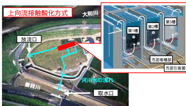
図 1.22 曾我川浄化施設
