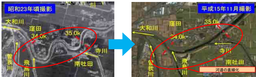
図 2.5 捷水路による瀬淵の減少(大和川 35k 付近)
