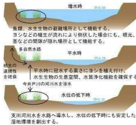
図 4.26 支川の河川水を利用した水際植生の再生イメージ(大和川 7.2km)
