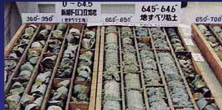
● 地質ボーリング調査で得られたコアサンプル
