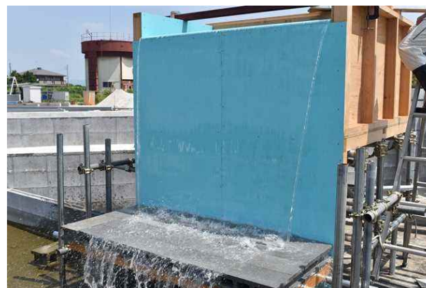
実験状況(越流水深2cm、水面変動なし)
