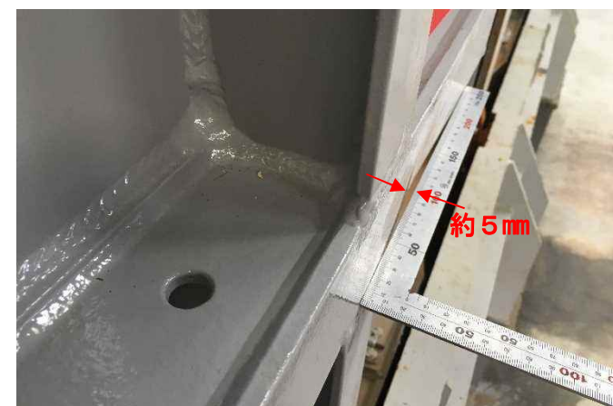
約230kg、90° で衝突後（接写）
