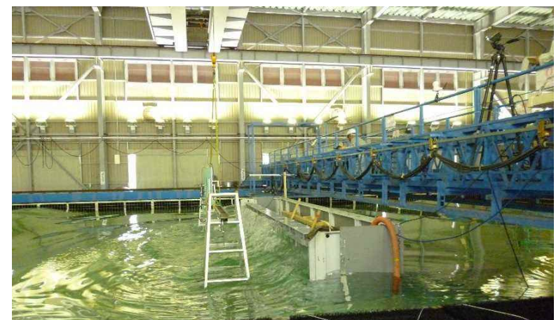
実験状況 (ケース④ h=0.8m、波向き90°、越水時)
