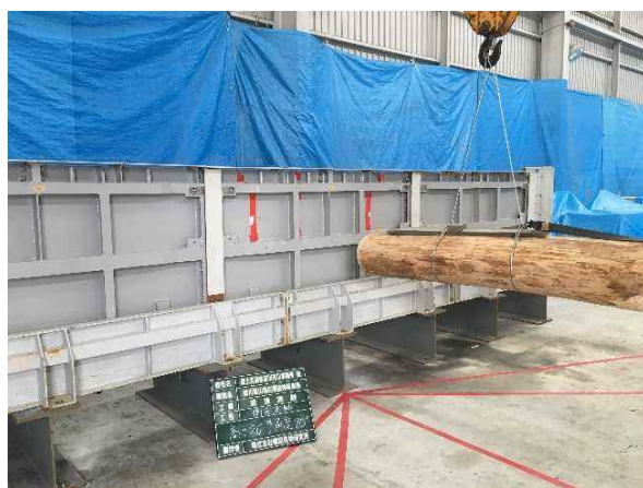
衝突実験状況（重り70kg）
