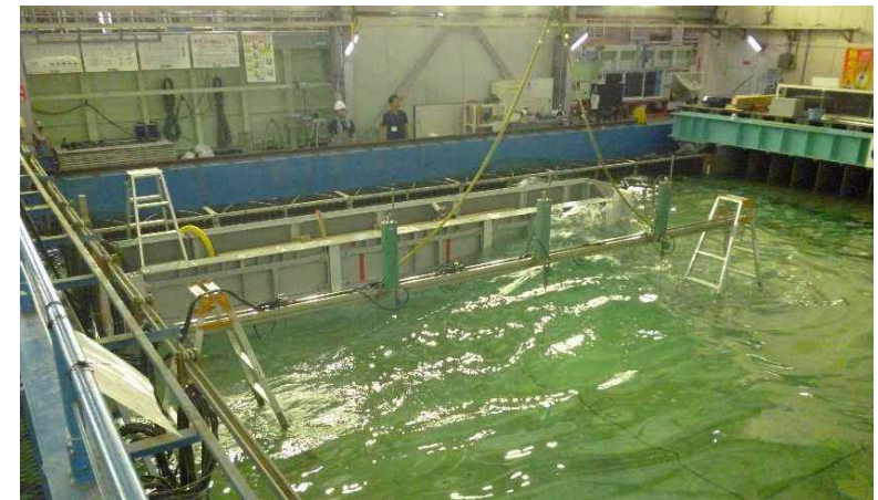
実験状況 (ケース② h=0.8m、波向き30°)
