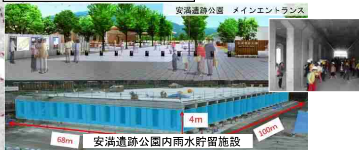
雨水貯留浸透施設整備
