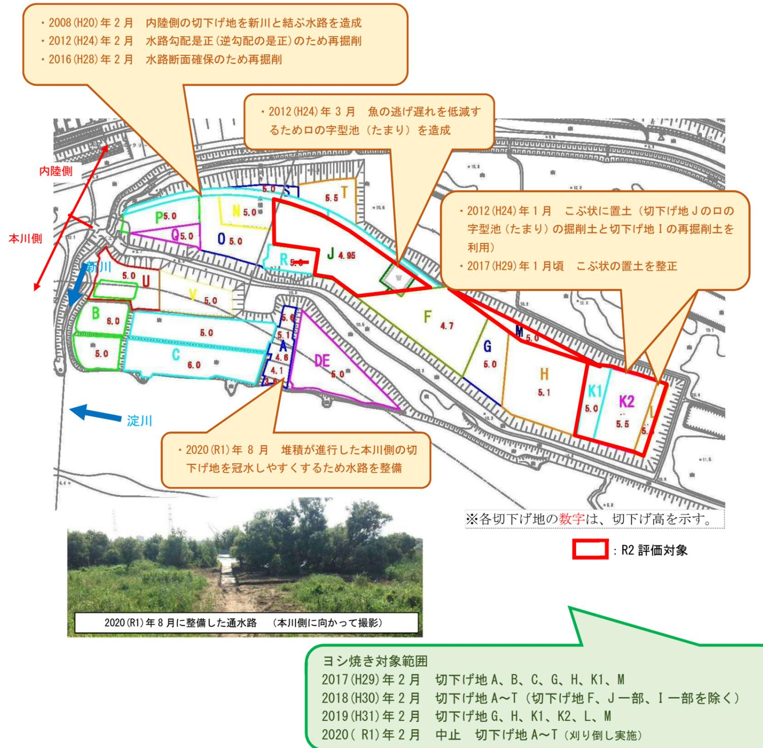
図3 切下げ地位置・切下げ地整備高さ・切下げ地整備後の維持的措置
