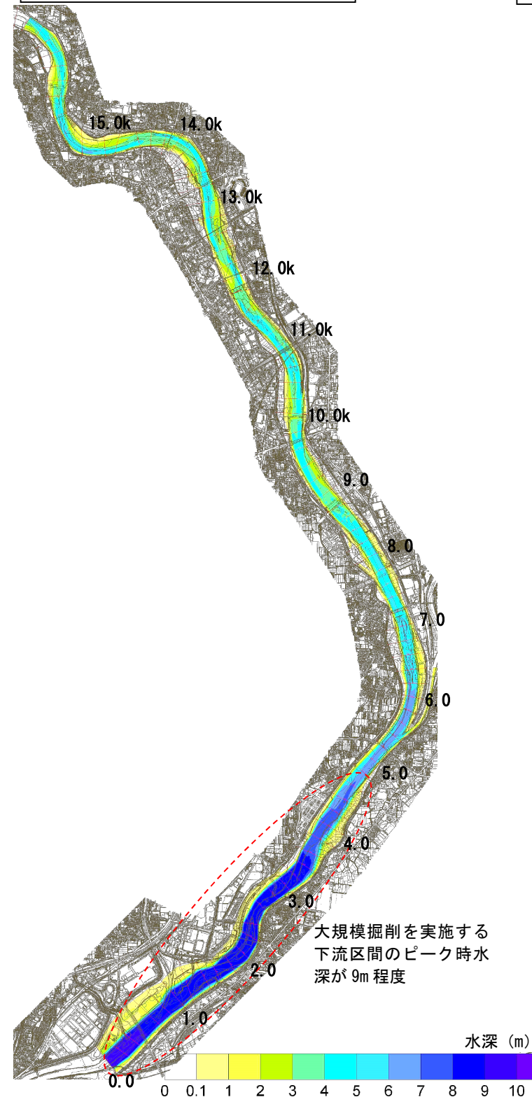
図 4.15 参考：河床変動予測における洪水ピーク時（H30.7洪水相当）の掃流力、水深及び流速コンター図
