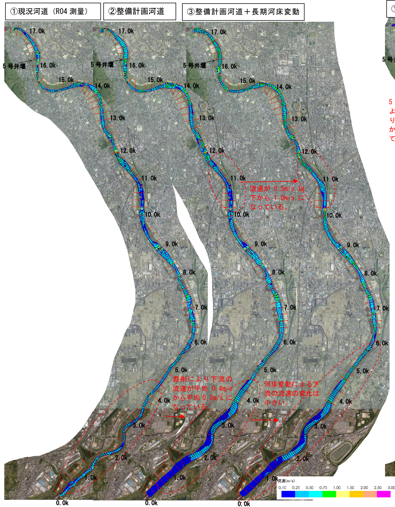
図 4.8 河床変動前後の平水時流速分布図
