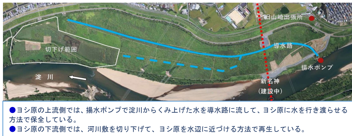
★導水路は二方向に設置したが、現在は堤防側の導水路に通水している。 図 2 鵜殿地区の保全対策位置
