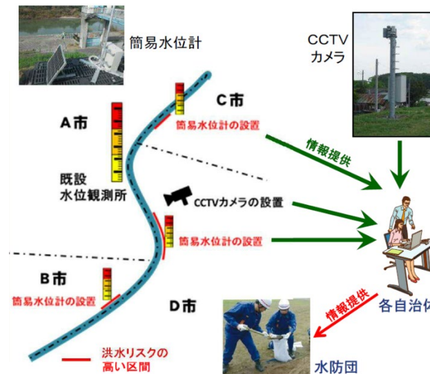
水害リスクが高い箇所リアルタイムに水位を把握するための簡易水位計の設置
