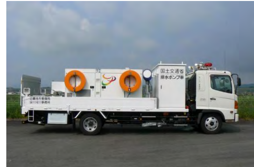
排水ポンプ車
