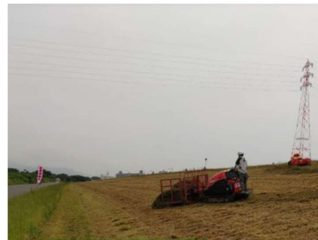
◀遠隔操作式草刈機 による集草状況
