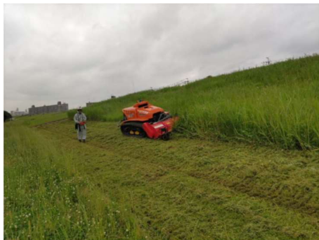
◀遠隔操作式草刈機 による除草状況
