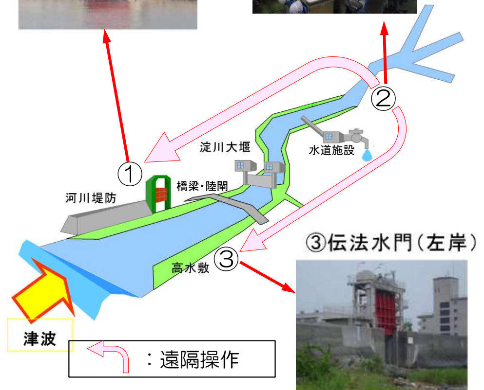
▲ 津波発生時の集中管理センターにおける水門の遠隔操作
