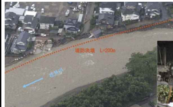
河岸侵食による家屋倒壊及び流出
