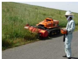
大型遠隔操縦式除草機による除草作業
