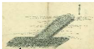
1 クレップ水制工
