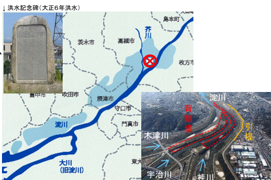
三川合流点に背割堤を設置
