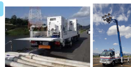
排水ポンプ車
