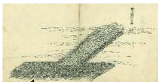
1 クレップ水制工
