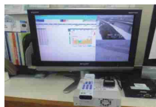
簡易水位計 表示装置
