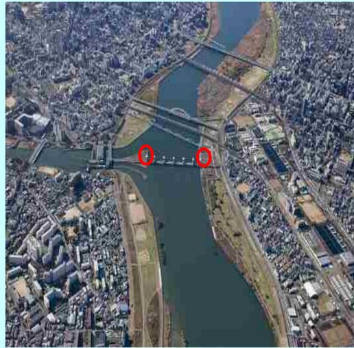
淀川大堰は淀川の河口から約9kmに位置し、塩水の遡上を防止し、淀川での安定した取水と大阪市内河川へ淀川の水を分流するのに役立っています。その淀川大堰の左右岸には、上流側の水位に追従して階段状の隔壁が可動する魚の通り道（魚道）が設置され、毎年春になるとアユの遡上が見られます。
