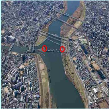
淀川大堰は淀川の河口から約10kmに位置し、塩水の遡上を防止し、淀川での安定した取水と大阪市内河川へ淀川の水を分流するのに役立っています。その淀川大堰の左右岸には、上流側の水位に追従して階段状の隔壁が可動する魚の通り道（魚道）が設置され、毎年春になるとアユの遡上が見られます。
