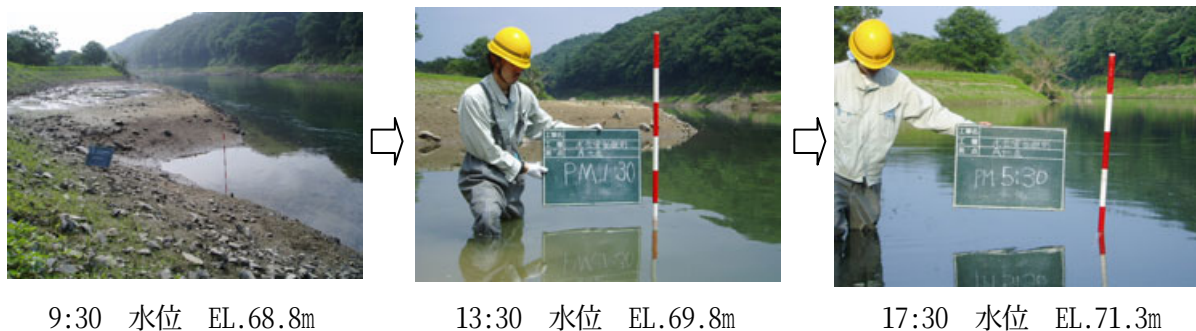
図 2.2-12 貯水池上流端付近の水位変動の状況 (観測日：平成 16 年 7 月 1 日)
