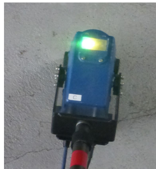
写真-2 健全[LED点灯]
