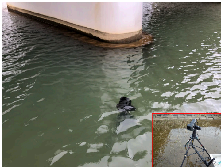
写真-1 計測状況(スキャニングソナー)
